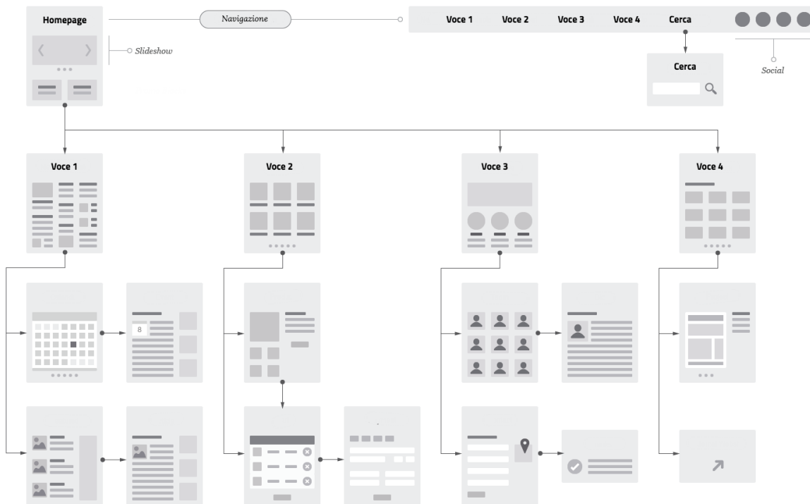
Fig. 5.1: Un esempio di wireframe , o prototipo a «bassa fedeltà».
